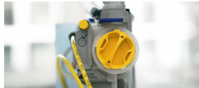
Colocación del colector cuando hay una válvula de drenaje de la escupidera
