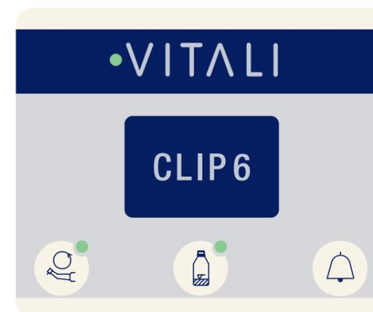
Bedienfeld mit Taste für Drehzahlumkehr des Mikromotors, Druckbehälter-Füllstandsanzeige, Helferinnenruf.
